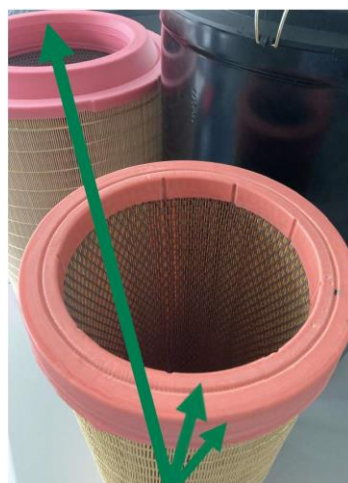
Le couvercle de l'élément secondaire et le côté intérieur de l'élément principal doivent être graissés
