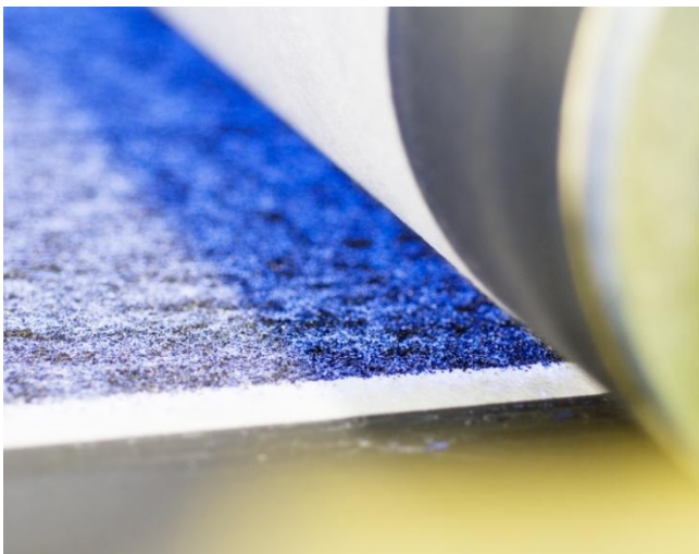
Filtermedienproduktion: Belegung mit Aktivkohle
