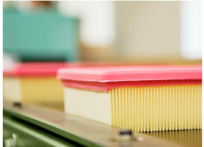
Luftfilter in der Fließfertigung
