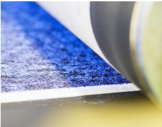
Filtermedienproduktion: Belegung mit Aktivkohle
