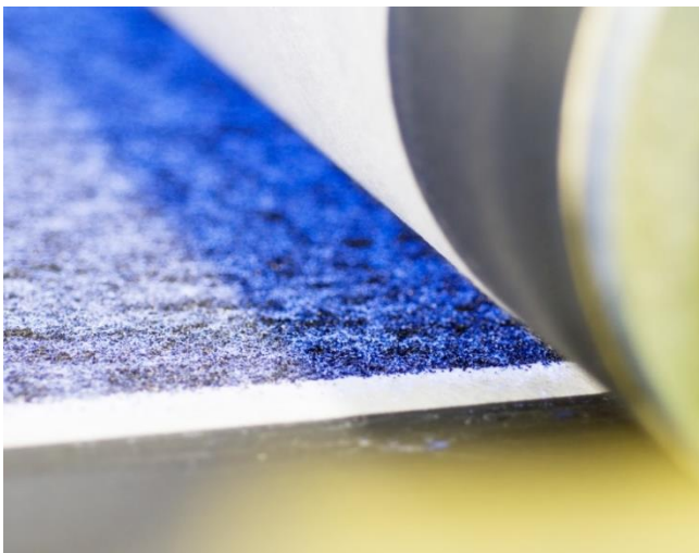
Filtermedienproduktion: Belegung mit Aktivkohle
