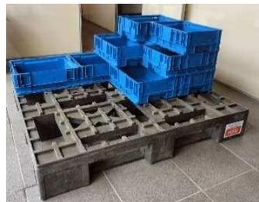
As caixas padrão KLT Fundo Lego permitem o empilhamento de forma que o encaixe do fundo evite deslocamentos durante o transporte e descarregamento.
