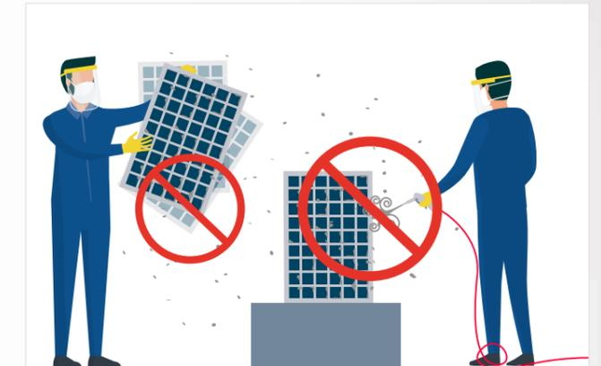
**Gehen Sie vorsichtig mit benutzten Filtern um!** Vermeiden Sie es, den im Filter gesammelten Staub durch schütteln oder mit Druckluft zu entfernen, da sonst Partikel in die Luft gelangen.
